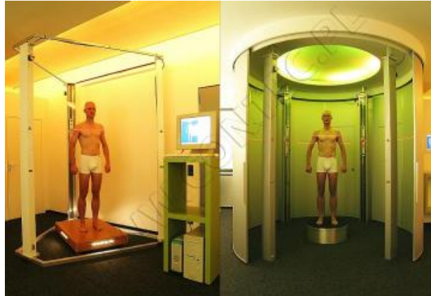
Rys. 13. Laserowy skaner 3D Vitus XXL firmy Human Solutions do pomiarów antropometrycznych [22].
